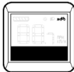
Anzeige der 6-km/h-Schiebehilfe
